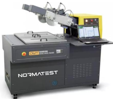
MÁQUINA WHEEL TRACKING DE UNA RUEDA
