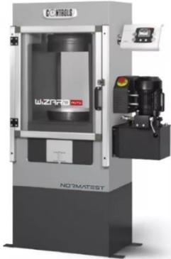
PRENSA AUTOMÁTICA PARA ENSAYOS DE COMPRESIÓN
