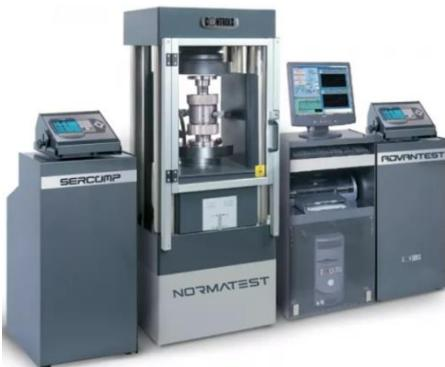
SISTEMA AUTOMÁTICO DE ENSAYO TRIAXIAL EN ROCAS
